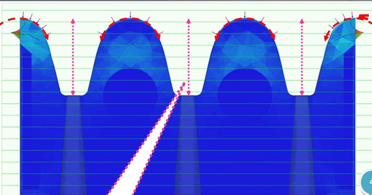
La sezione ad arco delle barre in superficie è progettata per rilasciare la forza d'urto lungo i lati delle barre stesse
